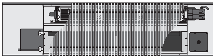
Системный конвектор с тангенциальным вентилятором QSK НК 320 или QSK НК 360 (2-х трубный)
